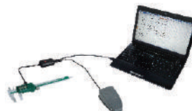
Cabos de Saída de Dados
